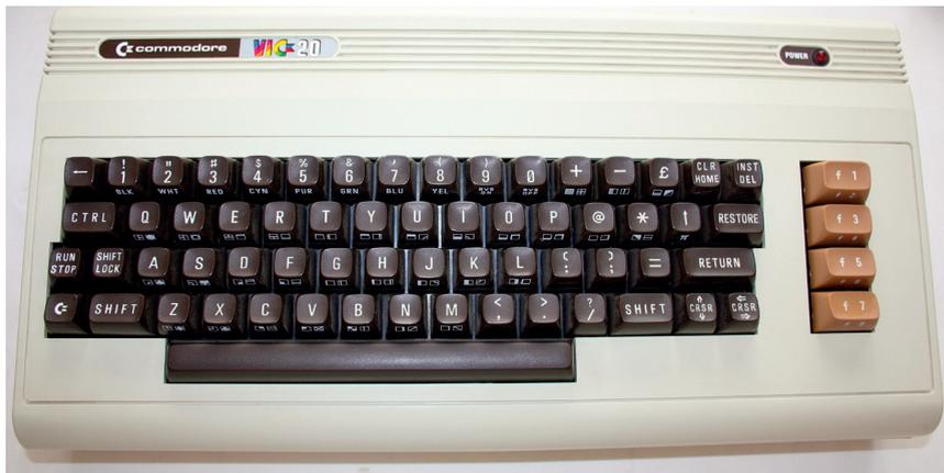
Figura 1.3. El VIC-20 era un microordenador típico que incorporaba todos los elementos dentro del propio teclado.
